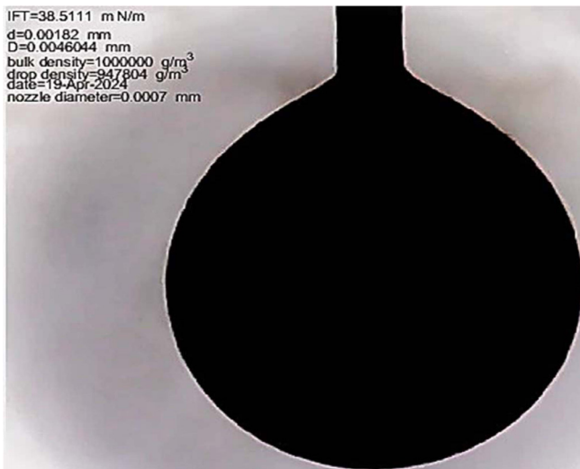
Fig. 7 Schematic of pendant drop.
