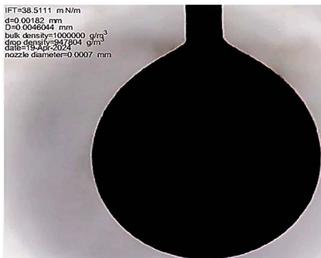
Fig. 7 Schematic of pendant drop.
